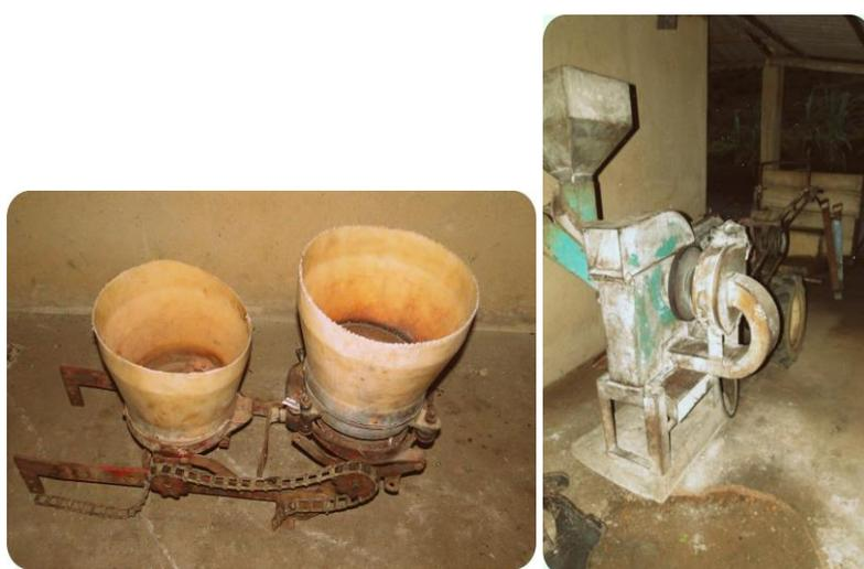
**Figura 12: Máquina para plantio de feijão em áreas com declividade em processo de elaboração e máquina de moer milho adaptada ao motor da tobata.**
